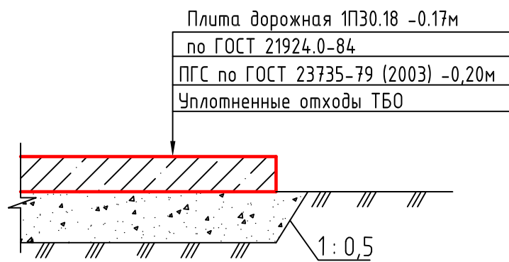
Конструкция дорожного покрытия технологического проезда
